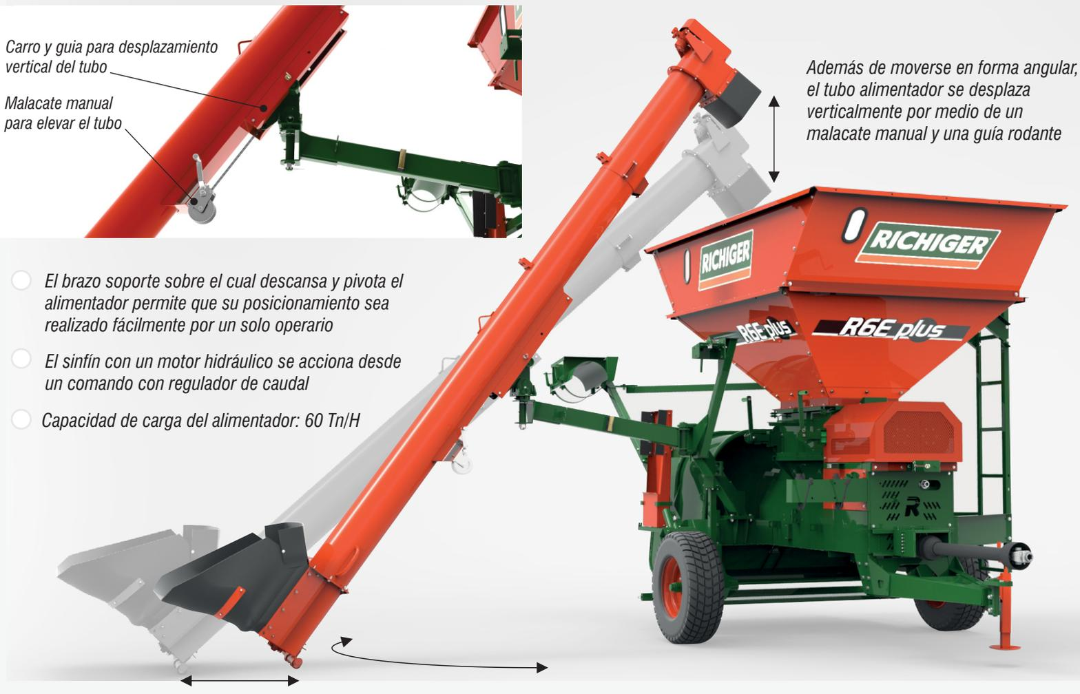
Carro y guía para desplazamiento vertical del tubo
